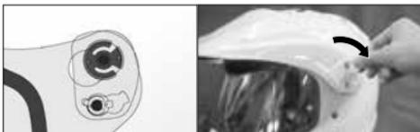
Dient u de schroeven, drukplaatjes en klemplaatjes voor te monteren op de klep, waarbij u er voor zorgt dat het smalle deel van de klemring aan beide zijden naar boven is gericht.
