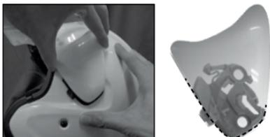
Para volver a instalarla, con la visera en su posición totalmente abierta, tal y como estaba cuando se retiró, coloque el pivote/soporte sobre la placa de sujeción con los bordes inferior y posterior del soporte alineados a la placa base, como se muestra en el gráfico.
